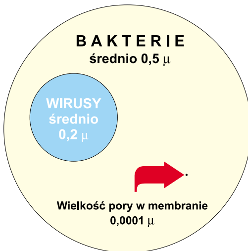
Rys. 32. Porównanie pory membrany osmotycznej z bakterią i wirusem.
